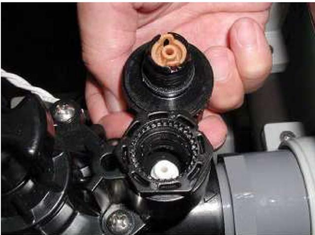
☞ **この状態で、コントローラの手動スイッチで電磁弁を数回開閉させる。コイル内部の小さなゴミが取れます。**
